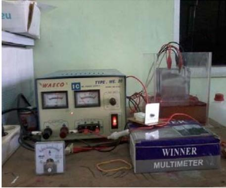
Gambar 1. Alat Elektrokoagulasi untuk air limbah batik<sup>4)</sup>
